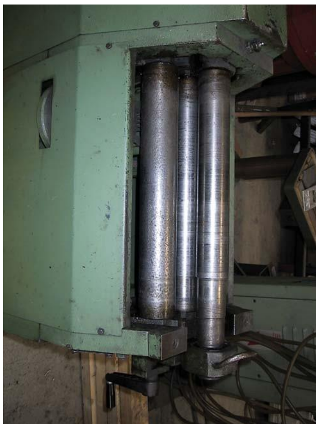
Figura 1 – Vista di insieme di una calandra a quattro rulli
