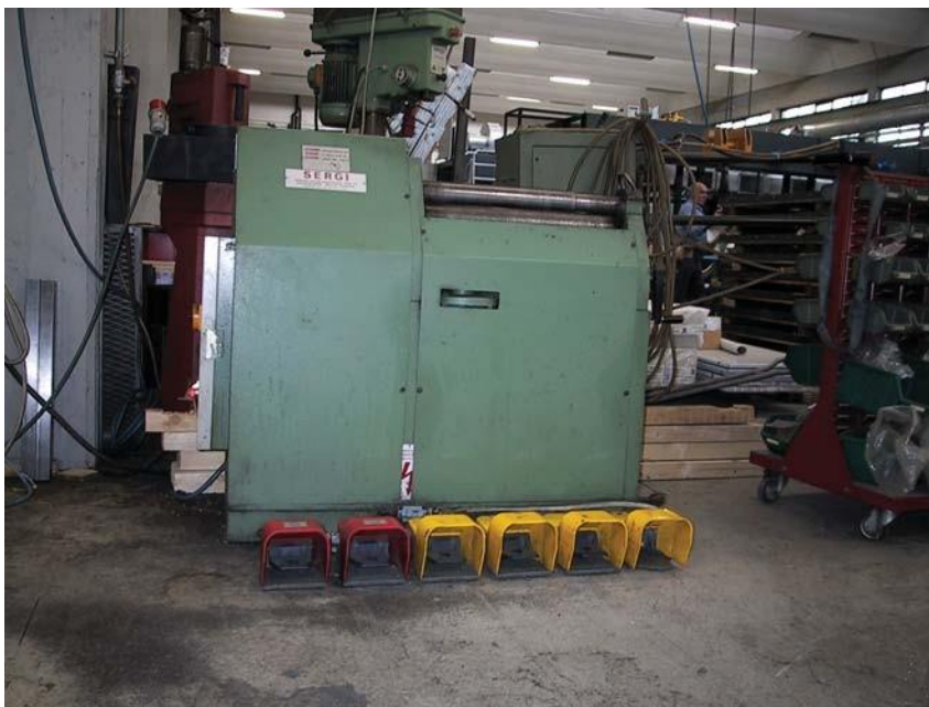
Figura 1 – Vista di insieme di una calandra a quattro rulli
