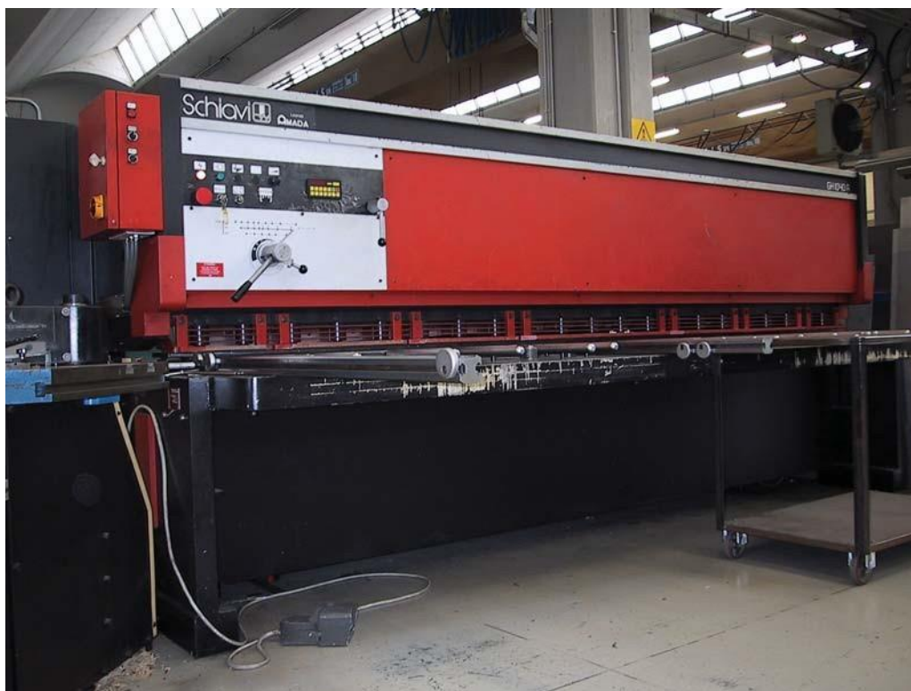
Figura 1 – Vista di insieme di una cesoia
