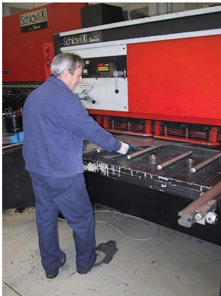
Figura 4 – Operazioni di taglio con uso di pedaliera ad uomo presente
