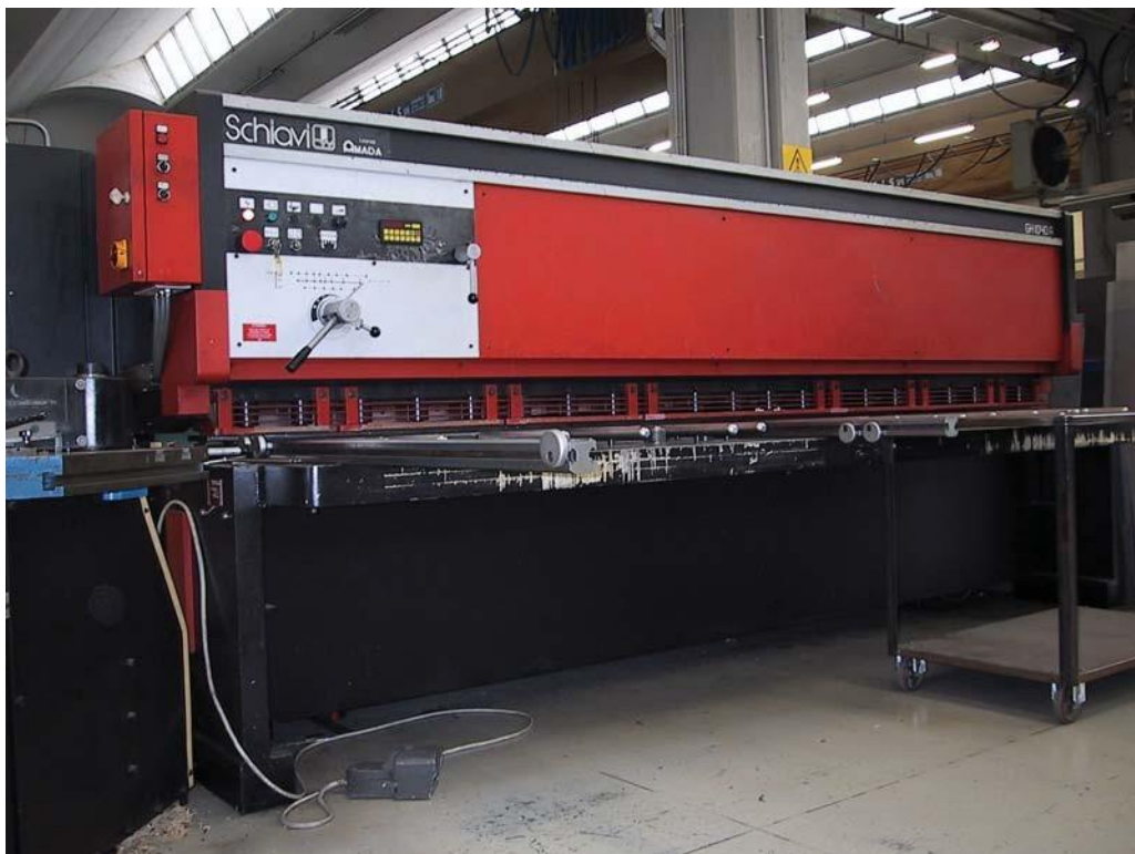
Figura 3 – Quadro di comando cesoia
