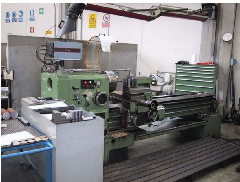
Figura 4 – Manicotto con dispositivo di blocco che NON circonda il mandrino in posizione di lavoro
