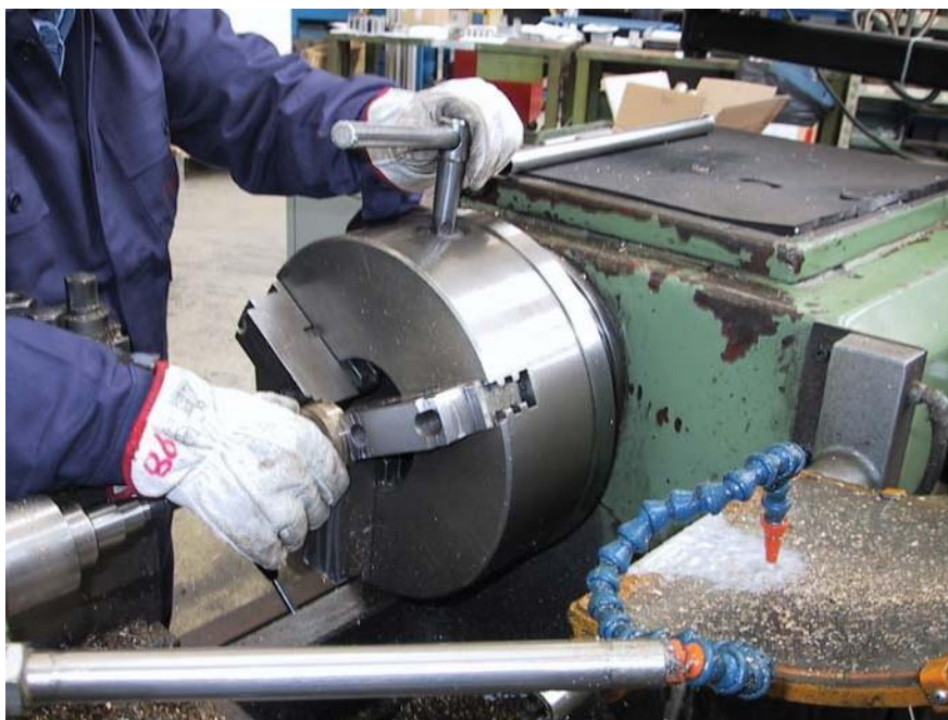
Figura 2 – Operazione di serraggio del pezzo
