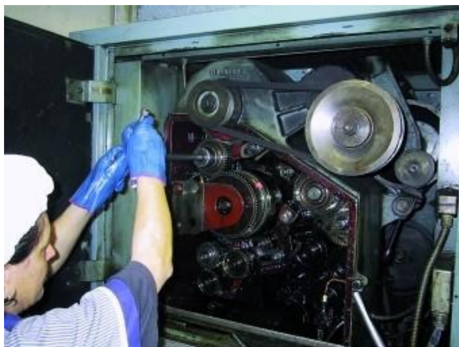
Figura 4 - Operazione per la regolazione del sistema di stiro
